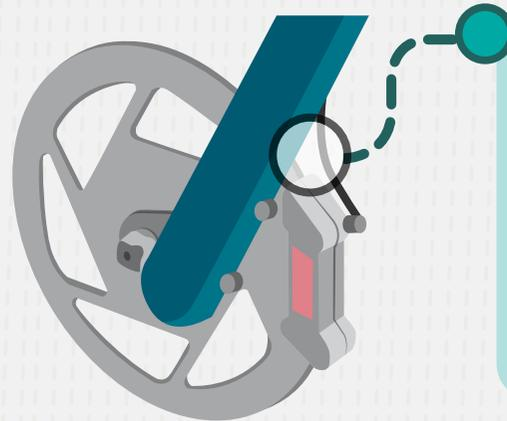
Este sistema de frenado está formado por un rotor, que está fijo al buje con tornillos y un cáliper o pinza con dos zapatas que al accionarse, presionan ambas caras del rotor. Hay por accionamiento mecánico (mediante un chicote) e hidráulicos. Sólo pueden instalarse en horquillas y cuadros especialmente diseñados para ellos.
